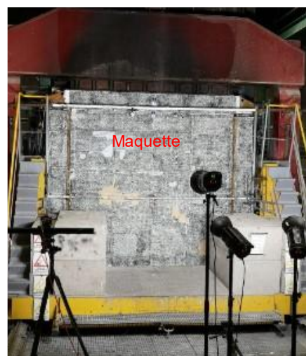
Figure 9 – Dispositif expérimental des essais de résistance au feu (CSTB) : instrumentation mise en place et maquette du mur maçonné en pierre calcaire (mouchetis appliqué sur le mur)
