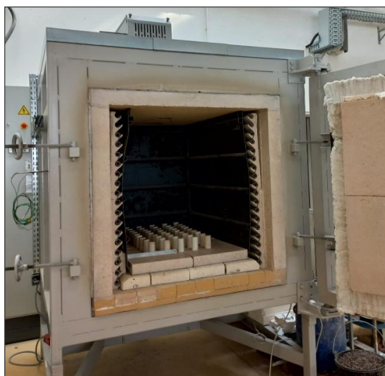
Figure 6 – (à gauche) : four électrique permettant des chauffes jusqu'à 900 °C (CYU) ; (à droite) : paramètres des cycles de chauffage-refroidissement théoriques et expérimentaux
