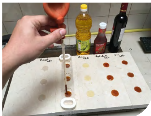
Essai de tachabilité en laboratoire entre la pierre et le traitement de protection
