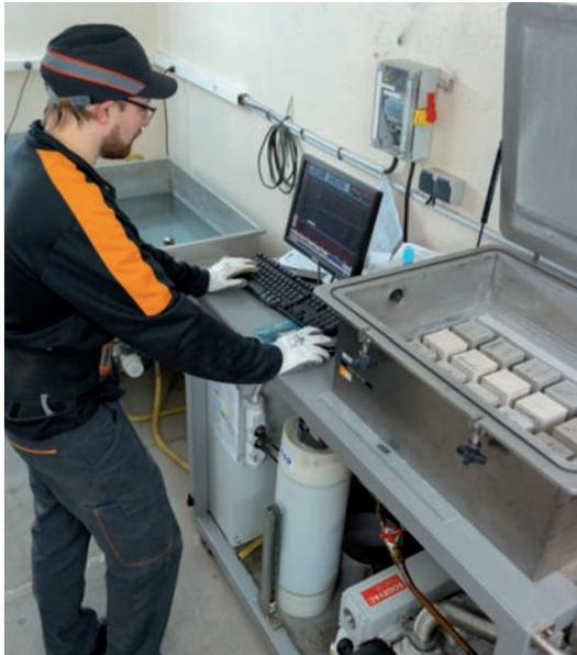
*Essai de Masse volumique apparente et porosité ouverte selon la NF EN 193.*
