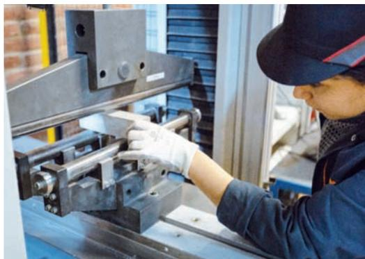
*Essai de flexion sous charge centrée selon la NF EN 12372.*
