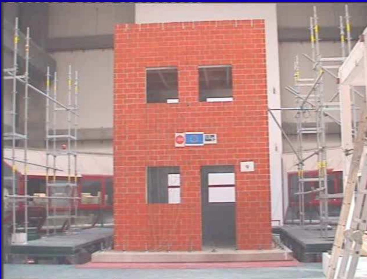
Essai sur table vibrante d'une maison en maçonnerie non chaînée
