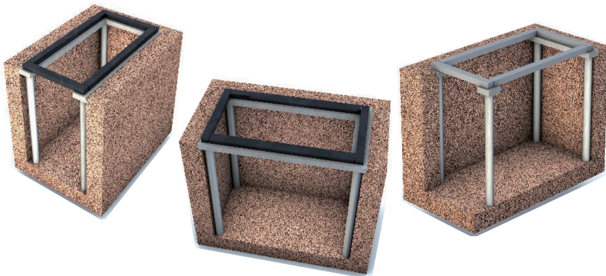
Figure 5. Fondation simple par longrines sur les 3 côtés reliés à des pilotis en béton armé
