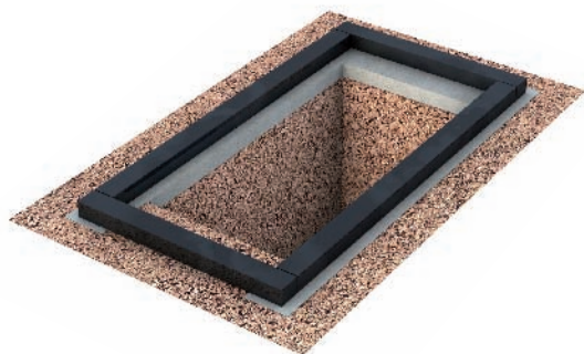
Figure 4. Fondation/assise simple par longrines sur les 3 côtés
