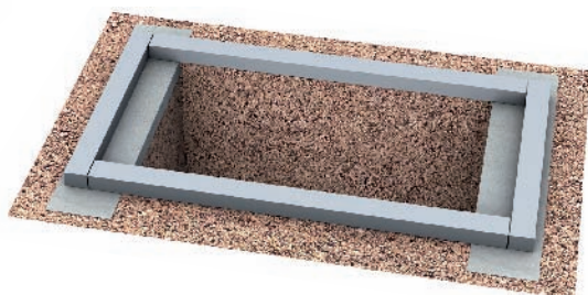
Figure 3. Fondation/assise simple par longrines à l'avant et à l'arrière
