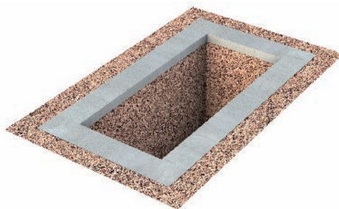
Figure 6. Semelle en béton préfabriqué ou coulée en place sur le bon sol
