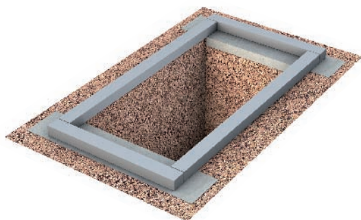
Figure 3. Fondation/assise simple par longrines à l'avant et à l'arrière
