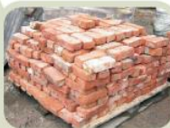
STOCKAGE APRÈS DÉCONSTRUCTION
