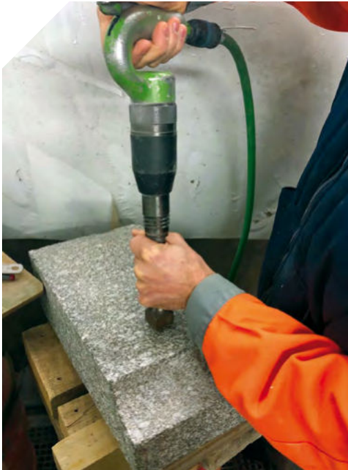
Opération de bouchardage
