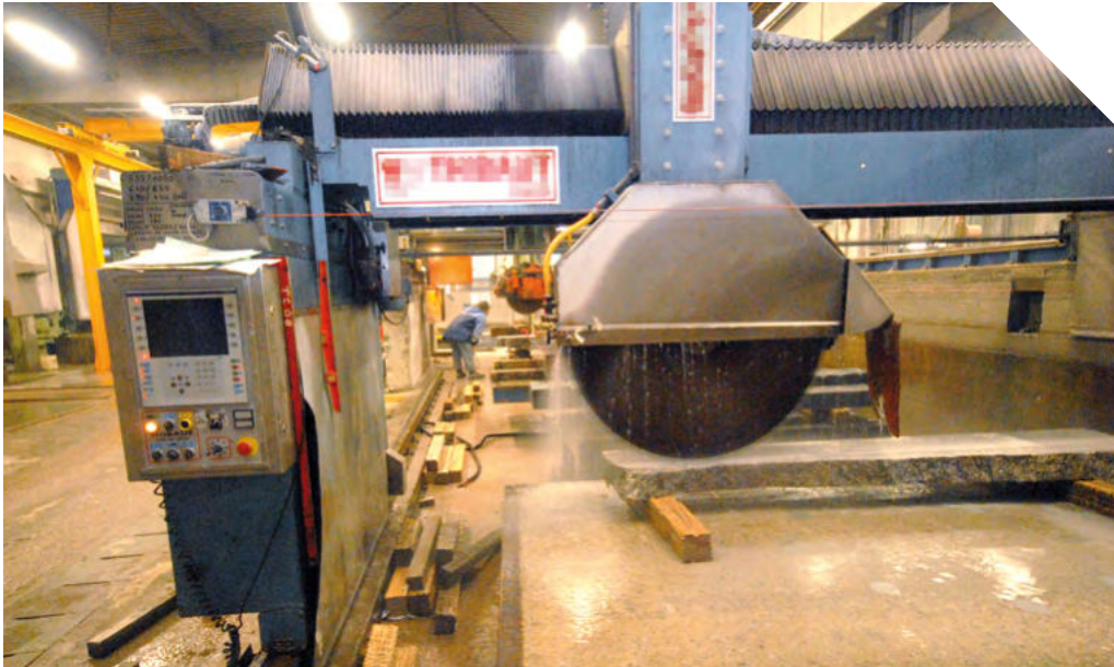
Débitage secondaire au disque diamanté
