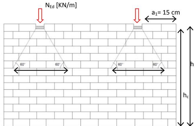
Fig.4 Mur soumis à des charges concentrées
