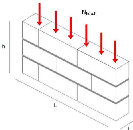
Fig.1 Mur porteur soumis à une charge verticale
