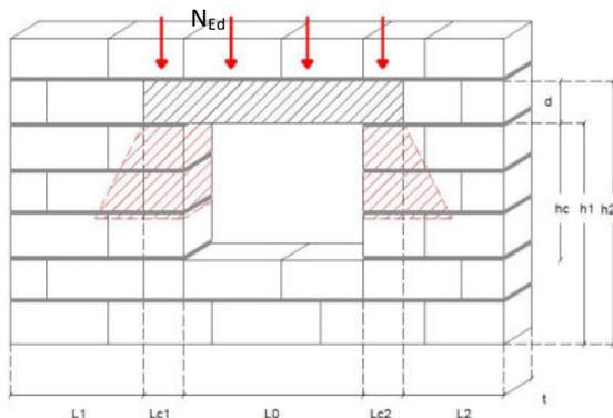
Fig.7 Configuration du mur avec ouverture : chargement mur et linteau
