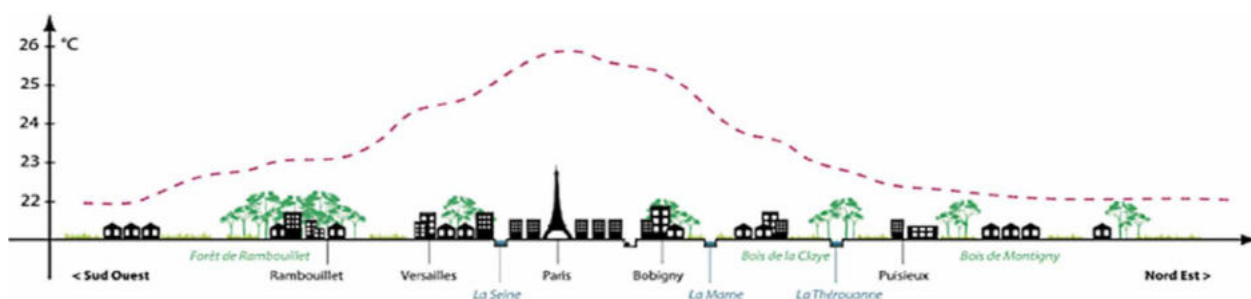
Coupe schématique de visualisation des températures en 2008 pour une nuit de canicule (type été 2003) Source : Groupe DESCARTES - Consultation internationale de R&D sur le projet du Grand Paris, février 2009
