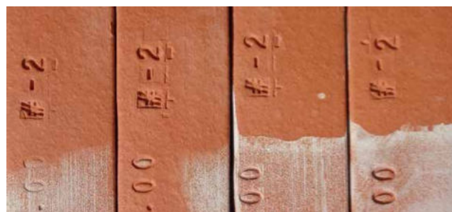
Eprouvettes obtenues après application du revêtement substitutif au \text{BaCO}_3 sur une partie de la surface d'échantillons en terre cuite
