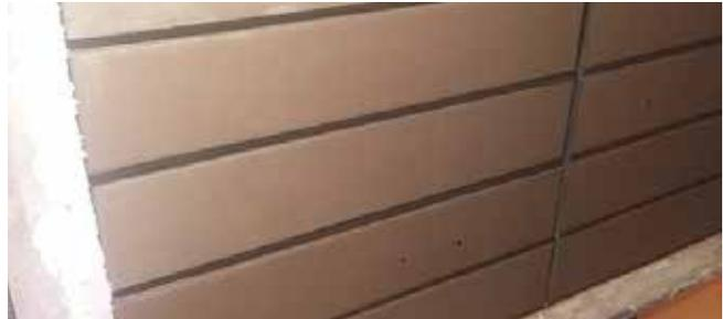
**Essai selon prNF EN 772-22 : Aucune dégradation**
