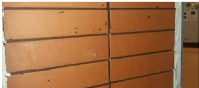
**Photo n° 4 :** Aspect des briques à l'issue des 100 cycles de gel/dégel selon prNF EN 772-22 : points blancs moins nombreux (par rapport aux briques testées selon la méthode de la plaque froide)
