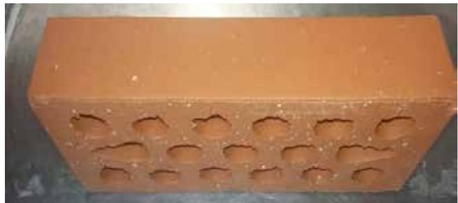
**Photo n° 3 :** Apparition de petits points blancs localisés sur les faces au contact de la plaque froide
