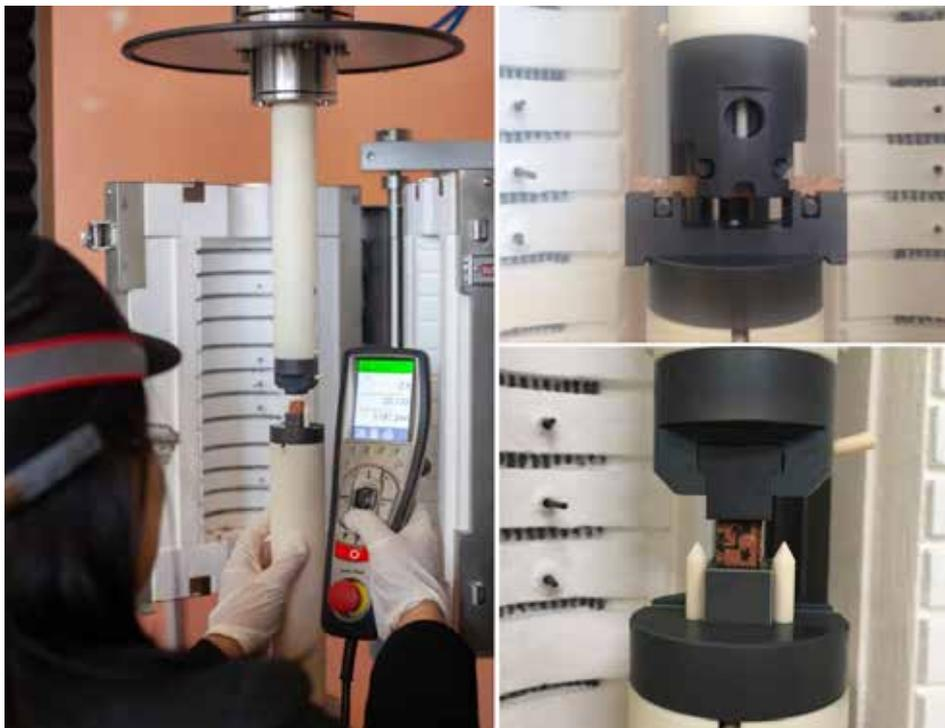
Utilisation de l'équipement d'essai mécanique à chaud
