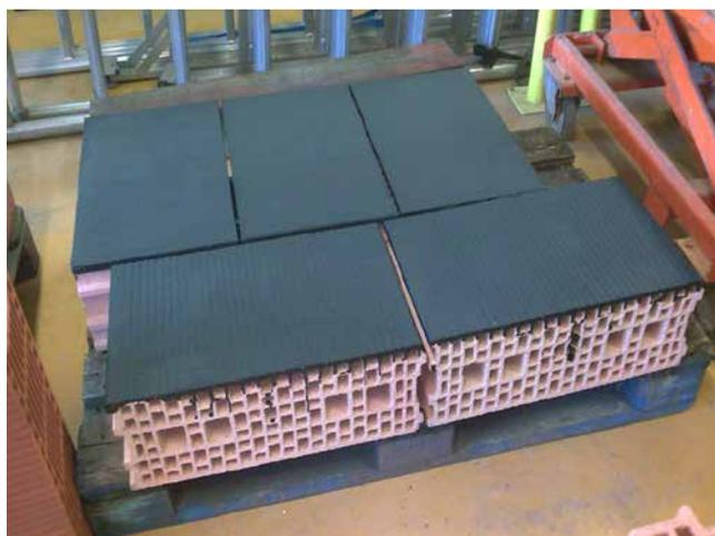
Sur briques P revêtues d'un enduit bitumineux
