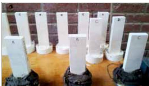
Dispositif de l'essai de Venuat.
