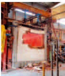
En outre, des murs porteurs en briques de terre cuite de 20 cm d'épaisseur, protégés sur une face par un doublage laine de roche, ont été testés au feu aux Laboratoires du CSTB et d'Efectis France, sur différents produits. Les résultats d'essais montrent que, la grande majorité des murs tient au feu plus d'une heure (dans certains cas jusqu'à 4 ou 5 heures) et pour certains sous une charge proche de la charge maximum à froid.
