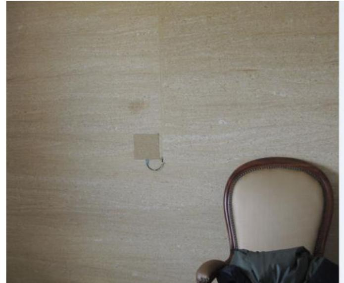
Fluxmètre sur mur intérieur
