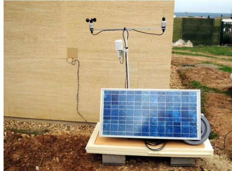
La centrale de mesure est alimentée par un panneau solaire qui recharge une batterie.
