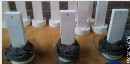
Dispositif de l'essai de Venuat
