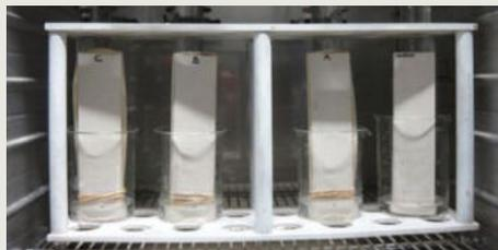
Dispositif de l'essai de compatibilité de l'annexe A de la NF DTU 52.2 P1-2
