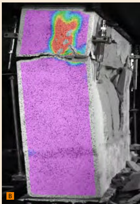
Résistance d'un trumeau à une sollicitation de compression excentrée de e_{mur}/6 , à température ambiante : (a) Maquette testée, (b) Mécanisme de rupture observé par corrélation d'images, (c) Mécanisme de rupture obtenu par l'approche cinématique numérique du calcul à la rupture (droits d'images : Elodie Donval, Thèse de doctorat)
