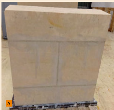
Résistance d'un trumeau à une sollicitation de compression excentrée de e_{mur}/6 , à température ambiante : (a) Maquette testée, (b) Mécanisme de rupture observé par corrélation d'images, (c) Mécanisme de rupture obtenu par l'approche cinématique numérique du calcul à la rupture (droits d'images : Elodie Donval, Thèse de doctorat)
