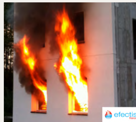
Exemple de réalisation d'un essai LEPIR II par la société Efectis France (laboratoire Les Avenières, Isère (38)) - Photo : Efectis France
