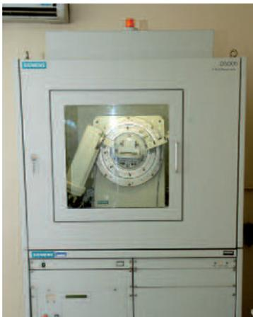
Diffractomètre à rayons X.
