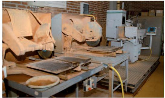
Le laboratoire de Clamart est doté d'un véritable atelier, qui lui permet de préparer les matériaux avant les essais.
