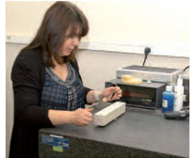
Mesure de la fréquence de résonance.
