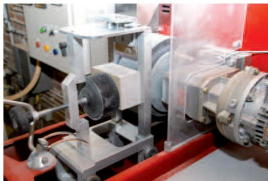
*Machine Capon pour l'usure au disque.*
