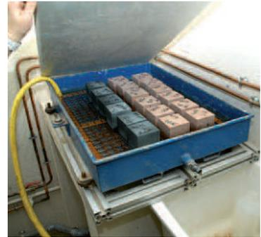
Caisson d'imbibition pour la mesure de capillarité.
