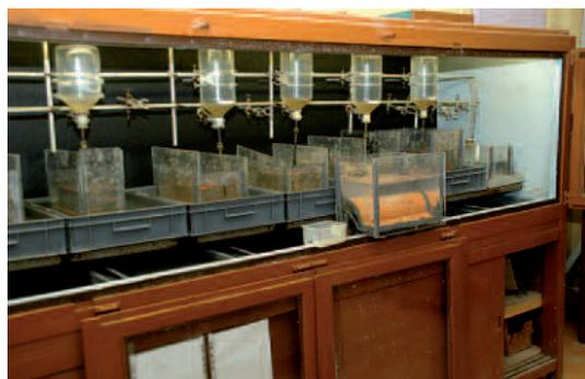
*Caisson pour mesure de la perméabilité NF.*
