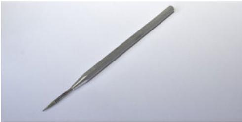
**Pointe diamant** : cet outil permet de tracer facilement sur les matériaux durs ; il raye la surface.
