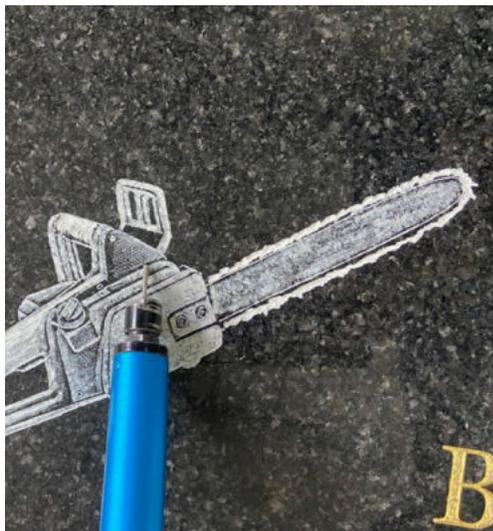
**La Lithogravure** : technique artisanale utilisée de préférence sur des granits foncés pour un meilleur contraste. Elle a pour but de rayer légèrement la pierre à l'aide d'un outil fin, généralement une pointe à diamant. Une peinture blanche peut être appliquée afin de recouvrir les creux ainsi créés. Elle est utilisée pour les dessins, les portraits, et nécessite que le professionnel soit très bon dessinateur puisque son travail se fait directement à la main.
