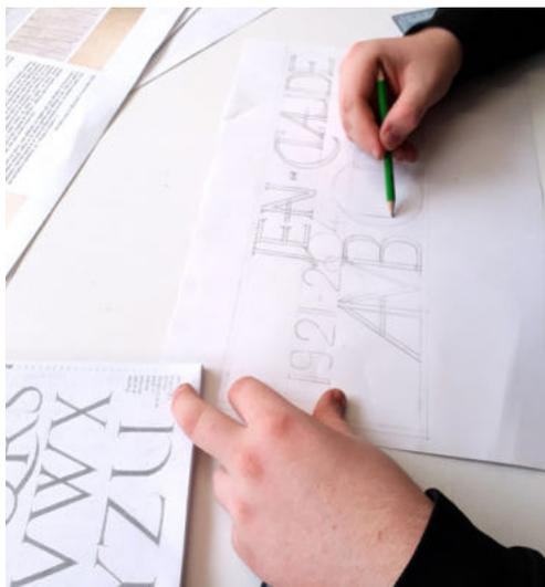
**Projet sur papier :** Il est toujours plus aisé et plus sûr de réaliser au préalable un dessin technique. Ceci permet de bien proportionner la taille du texte et sa disposition sur le support (plaque, stèle,) en donnant une vue d'ensemble. Cette opération est importante lorsqu'on travaille pour une commande d'un client : ceci évite les erreurs d'orthographe ou de date et permet de faire valider le projet au client avant réalisation.
