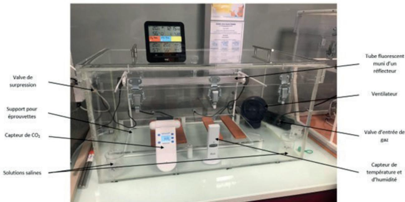
Description de la « **CO<sub>2</sub> Box** », développée par le CTMNC pour évaluer la capacité des produits de terre cuite à capter le  $\text{CO}_2$  atmosphérique
