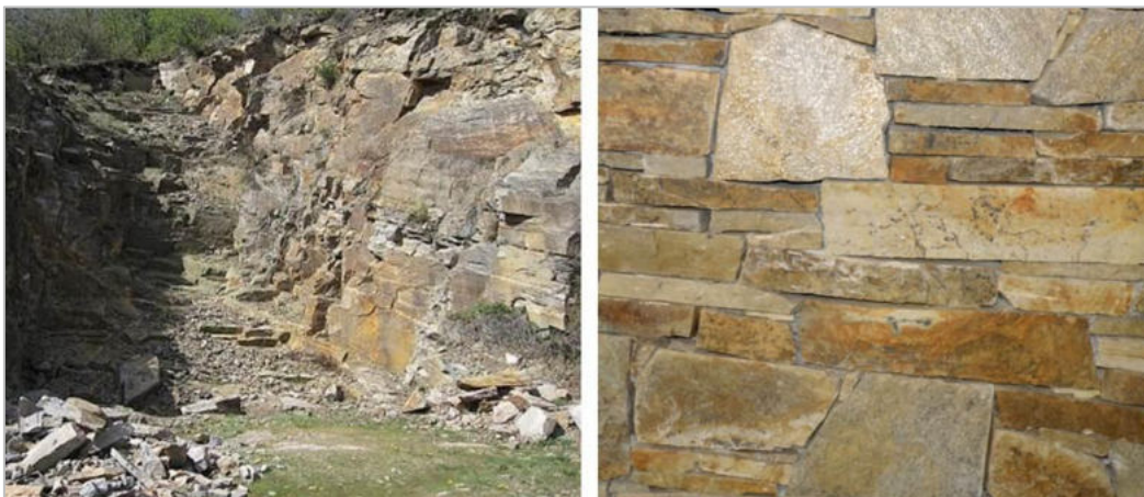
Figure 24 – Carrière de Gneiss du Caroux à Rosis (34) et mise en œuvre de Gneiss de Saint-Yrieix-la-Perche (87) – Photos BRGM.
